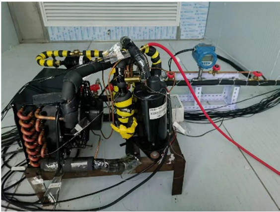
(a) 空气源热泵室外机组
